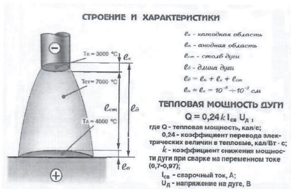
Рис. Тепловая мощность сварочной дуги.
