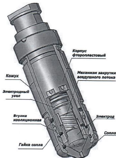
Рис. -конструкция плазматрона (схема)
